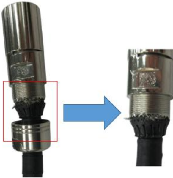
Ábra:5 .17 : Az árnyékolásoknak vezető kapcsolattal kell rendelkezniük a kör alakú csatlakozóval
